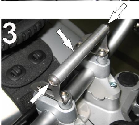
3.) Halterrohr zwischen Halter links und Halter rechts positionieren und mit 2 x Linsenkopfschraube M6x12 A2 verschrauben! (Bild3)
