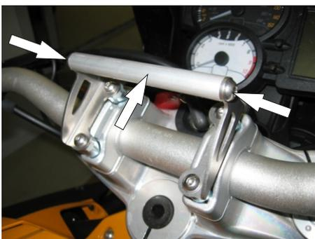
3.) Halterohr zwischen Halter links und Halter rechts positionieren und mit 2 x Linsenkopfschraube M6x12 A2 verschrauben! (Bild3)
